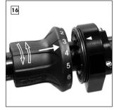
Zum Zusammenfügen beider Teile, Griffgummi in beliebiger Position bis Anschlag vor Seiltrommel schieben, Griffgummi langsam drehen bis es in Seiltrommel einrastet. Griffgummi bis Anschlag in Seiltrommel eindrücken.
