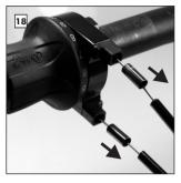
Zughüllen mit den Endkappen von den Schaltzügen entfernen.
