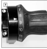
Griffelement so drehen, dass Markierung am Griffgehäuse mittig **zwischen Zahlen 8 und 9** liegt und in dieser Position halten. **Schaltzug 14** komplett in das Gehäuse einziehen, bis der Nippel sicher in der Seiltrommel fixiert ist.
