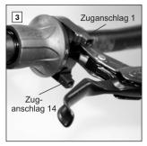
Schaltgriff auf rechtes Lenkerende (Lenkerdurchmesser 22 - 22.3mm) schieben und Griffgehäuse so drehen, dass die Zuganschläge gleichmäßig ober- und unterhalb des Bremsgriffes liegen.
