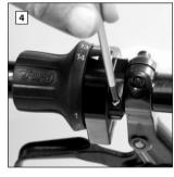
Beide Klemmschrauben (M3x12 - Torx TX20) mit leichter
