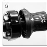
Zum Zusammenfügen beider Teile, Griffgummi in beliebiger Position bis Anschlag vor Seiltrommel schieben, Griffgummi langsam drehen bis es in Seiltrommel einrastet. Griffgummi bis Anschlag in Seiltrommel eindrücken.
