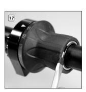
Sicherungsring wieder am Griffgehäuse montieren. Prüfen, ob sich Griffgummi leicht dreht.
