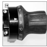
Griffelement mit montierten Zuganschlägen so drehen, dass Markierung am Griffgehäuse mittig zwischen Zahlen 8 und 9 liegt und in dieser Position halten.
