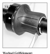
Zum Austausch des Griffgummis müssen die Schaltzüge nicht ausgebaut werden. Das Griffgummi kann einzeln gewechselt werden. Mit einem
