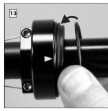
Vor der Montage des neuen Griffgummis den korrekten Sitz des O-Ring auf der Seiltrommel kontrollieren.
