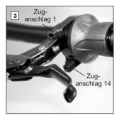
Schaltgriff auf linkes Lenkerende (Lenkerdurchmesser 22 - 22.3mm) schieben und Griffgehäuse so drehen, dass die Zuganschläge gleichmäßig ober- und unterhalb des Bremsgriffes liegen.
