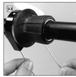
Einlegen der neuen Schaltzüge in das Griffgehäuse siehe Schaltzugmontage Bild 6 bis 11.
