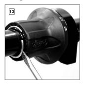
Wechsel Griffelement: Zum Austausch des Griffgummis müssen die Schaltzüge nicht ausgebaut werden. Das Griffgummi kann einzeln gewechselt werden. Mit einem schmalen Schlitzschraubendreher
