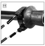
Montage Zughüllen mit integriertem Liner: Die Zuganschläge auf die Schaltzüge auffädeln und seitenrichtig bis Anschlag in das Griffgehäuse schieben. Zwischen Zuganschlag und Zughülle eine Zugendkappe einsetzen.
