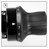
Griffelement so drehen, dass Markierung am Griffgehäuse mittig zwischen Zahlen 6 und 7 liegt und in dieser Position halten. Schaltzug 1 komplett in das Gehäuse einziehen, bis der Nippel sicher in der Seilrolle fixiert ist.
