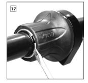
Sicherungsring wieder am Griffgehäuse montieren. Prüfen, ob sich Griffgummi leicht dreht.
