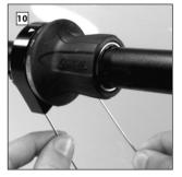
Zur Kontrolle wechselweise an beiden Schaltzügen bis Anschlag ziehen. Der Schaltgriff muss sich dabei leicht drehen und etwas über die Endpositionen 1 und 14 hinaus bewegen lassen.
