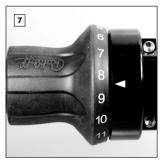
Griffelement so drehen, dass Markierung am Griffgehäuse mittig zwischen Zahlen 8 und 9 liegt und in dieser Position halten. Schaltzug 14 komplett in das Gehäuse einziehen, bis der Nippel sicher in der Seiltrommel fixiert ist.
