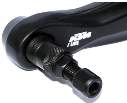
Mit dem Spider-Tool den Verschlussring lösen. (ACHTUNG : LINKSGEWINDE !)
