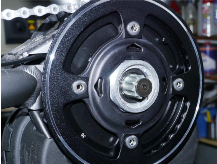
Jetzt die 3 Torx-Schrauben mit einem Torx T20 Schlüssel herausdrehen und den Steinschlagschutz seitlich entfernen.
