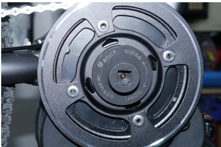
Jetzt kann man das Kettenblatt von der Welle lösen. Es kann sein das sich der Spider etwas auf der Welle verklemmt hat. Deshalb von hinten vorsichtig mit einem Stück Holz oder Schraubenzieher den Spider von der Welle hebeln.
